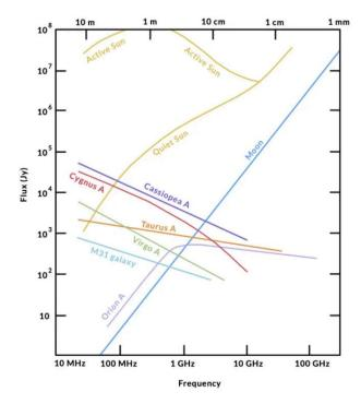
要为业余射电望远镜选择最合适的频段,我们必须在观测可能性与成本和可行性限制之间做出妥协。放射源发射的频谱取决于潜在的物理过程:对于太阳或月亮等"热"发射,强度遵循黑体定律,最大值为高频(根据 Rayleigh-Jeans I × 1/A4 的近似值),而对于非热发射(例如同步加速器发射),最大值为较低频率,如下图所示,该图显示了一些无线电源的强度与频率的函数关系。
